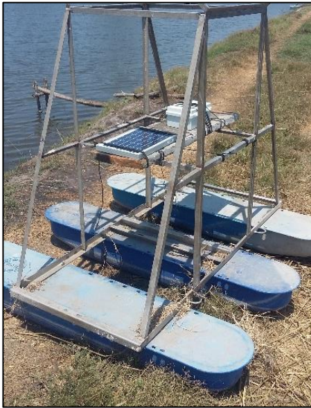
Figura 6. Dispositivo montado sobre la boya. Fuente propia.
