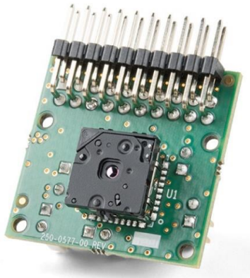
Fig. 1 Lepton FLIR camera.
